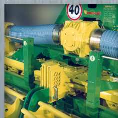
Registro rulli a spine Adjustment rollers with thorn Réglage rouleaux à épine Durch Stifte Einstellbare Walze
